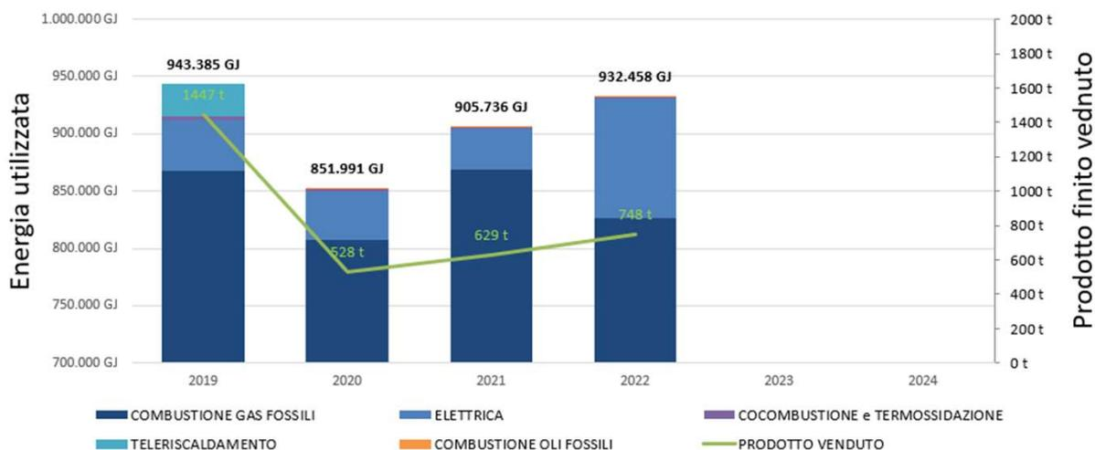
Dal 2019 le fonti di approvvigionamento energetico dello stabilimento sono costituite dall'energia elettrica e dal metano, quest'ultimo impiegato per il funzionamento delle caldaie e, soprattutto, per l'alimentazione dei trigeneratori. Queste due fonti costituiscono infatti più del 95% delle fonti energetiche per l'anno 2019 e più del 99% per gli anni seguenti. Nel 2019 permane infatti un consumo da TELERISCALDAMENTO, che dagli anni a seguire non alimenta più lo stabilimento.
